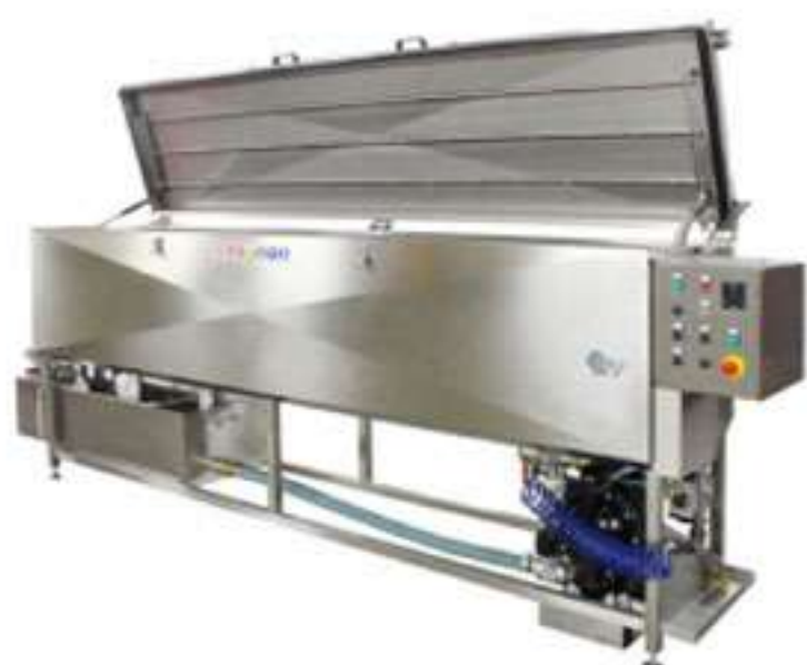
Lavadora Neumática de tinteros
